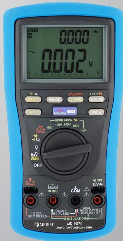
Das MD 9070 ist ein präzises Multimeter zur Isolations- und Durchgangsmessung, das in einer CAT IV / 600V-Umgebung verwendet werden kann. Auf dem Dual-Digital-Display werden dem Bediener alle erforderlichen Daten angezeigt. Die Größe ist so gewählt, dass es mit einer Hand bedient werden kann.
