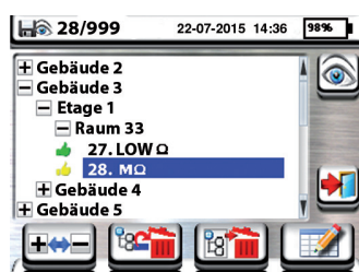
Speicherung Speicherung in 3 Ebenen
