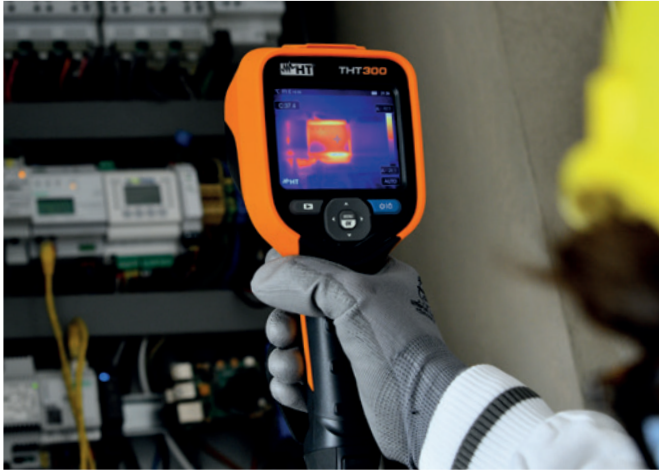
Ein überhitzer Lüftermotor aufgenommen mit der THT300
