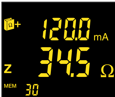
1. Anzeige: Impedanz und Fehlerstrom
