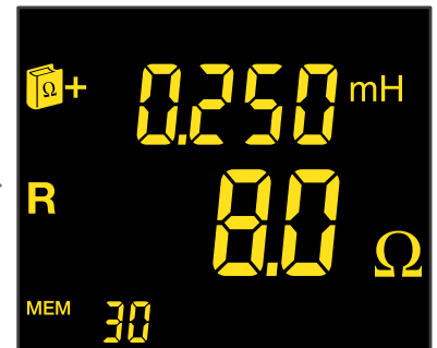
3. Anzeige: Wert des Widerstands- und Induktionsanteils der gemessenen Impedanz
